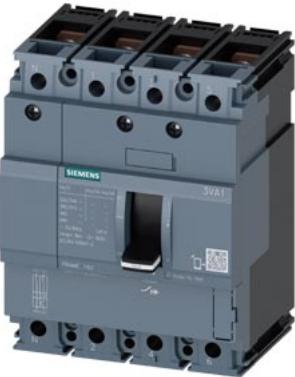
Interruttore automatico 3VA1 IEC Frame 160 Classe del potere di interruzione S Icu=36kA @ 415V a 4 poli, protezione impianto TM210, FTFM, In=63A protezione da sovraccarico Ir=63A impostazione fissa protezione da cortocircuito Ii=10 x In conduttore di neutro non protetto attacco piatto a vite
