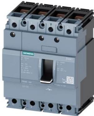
Sezionatore sottocarico 3VA1 IEC Frame 160 a 4 poli SD100, In=63A senza protezione da sovraccarico senza protezione da cortocircuito attacco piatto a vite
