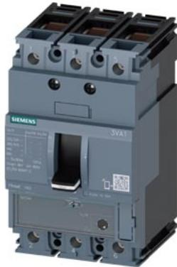
Interruttore automatico 3VA1 IEC Frame 160 Classe del potere di interruzione H Icu=70kA @ 415V a 3 poli, protezione avviatore TM120M, AM, In=50A senza protezione da sovraccarico protezione da cortocircuito Ii=7 ... 16 x In connessione a morsetto
