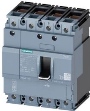
Interruttore automatico 3VA1 IEC Frame 160 classe del potere di interruzione M Icu=55kA @ 415V a 4 poli, protezione impianto TM210, FTFM, In=50A protezione da sovraccarico Ir=50A impostazione fissa protezione da cortocircuito li=10 x In protezione del conduttore di neutro 100% connessione a morsetto
