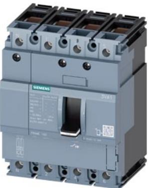
Interruttore automatico 3VA1 IEC Frame 160 Classe del potere di interruzione H Icu=70kA @ 415V a 4 poli, protezione impianto TM210, FTFM, In=40A protezione da sovraccarico Ir=40A impostazione fissa protezione da cortocircuito Ii=10 x In protezione del conduttore di neutro 100% connessione a morsetto
