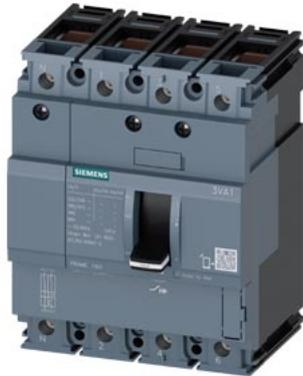
Interruttore automatico 3VA1 IEC Frame 160 Classe del potere di interruzione H Icu=70kA @ 415V a 4 poli, protezione impianto TM210, FTFM, In=40A protezione da sovraccarico Ir=40A impostazione fissa protezione da cortocircuito li=10 x In conduttore di neutro non protetto connessione a morsetto
