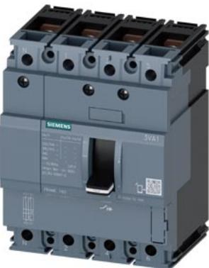
interruttore automatico 3VA1 IEC frame 160 classe del potere di interruzione S Icu=36kA @ 415V a 4 poli, protezione impianto TM210, FTFM, In=40A protezione da sovraccarico Ir=40 A con regolazione fissa protezione da cortocircuito li=10 x In conduttore di neutro non protetto attacco piatto a vite
