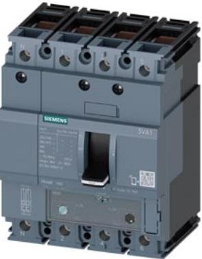
interruttore automatico 3VA1 IEC frame 160 classe del potere di interruzione S Icu=36kA @ 415V a 4 poli, protezione impianto TM240, ATAM, In=32A protezione da sovraccarico Ir=22 A ... 32 A protezione da cortocircuito Ii=5...10 x In protezione del conduttore di neutro 100% connessione a morsetto
