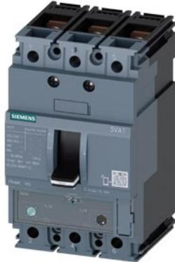
interruttore automatico 3VA1 IEC frame 160 classe del potere di interruzione S Icu=36kA @ 415V a 3 poli, protezione impianto TM240, ATAM, In=32A protezione da sovraccarico Ir=22 A ... 32 A protezione da cortocircuito Ii=5...10 x In attacco piatto a vite
