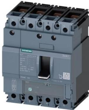
interruttore automatico 3VA1 IEC frame 160 classe del potere di interruzione N Icu=25kA con 415V a 4 poli, protezione impianto TM220, ATFM, In=32A protezione da sovraccarico Ir=22A...32A protezione da cortocircuito Ii=10 x In protezione del conduttore di neutro 100% attacco piatto a vite
