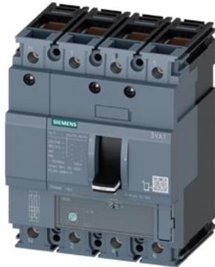
interruttore automatico 3VA1 IEC frame 160 classe del potere di interruzione N Icu=25kA @ 415V a 4 poli, protezione impianto TM220, ATFM, In=32A protezione da sovraccarico Ir=22 A ... 32 A protezione da cortocircuito Ii=10 x In conduttore di neutro non protetto connessione a morsetto
