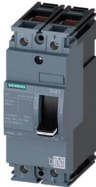
interruttore automatico 3VA1 IEC frame 160 classe del potere di interruzione N Icu=25kA @ 415V a 2 poli, protezione impianto TM210, FTFM, In=32A protezione da sovraccarico Ir=32A impostazione fissa protezione da cortocircuito Ii=10 x In connessione a morsetto
