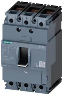
interruttore automatico 3VA1 IEC frame 160 classe del potere di interruzione N Icu=25kA @ 415V a 3 poli, protezione impianto TM210, FTFM, In=25A protezione da sovraccarico Ir=25A impostazione fissa protezione da cortocircuito Ii=12,8 x In attacco piatto a vite
