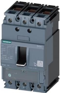
interruttore automatico 3VA1 IEC frame 160 classe del potere di interruzione H Icu=70kA @ 415V a 3 poli, protezione impianto TM220, ATFM, In=20A protezione da sovraccarico Ir=14 A ... 20 A protezione da cortocircuito Ii=16 x In in connessione a morsetto
