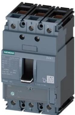
interruttore automatico 3VA1 IEC frame 160 classe del potere di interruzione S Icu=36kA @ 415V a 3 poli, protezione impianto TM220, ATFM, In=20A protezione da sovraccarico Ir=14 A ... 20 A protezione da cortocircuito Ii=16 x In connessione a morsetto
