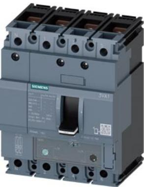
interruttore automatico 3VA1 IEC frame 160 classe del potere di interruzione N Icu=25kA @ 415V a 4 poli, protezione impianto TM240, ATAM, In=20A protezione da sovraccarico Ir=14 A ... 20 A protezione da cortocircuito Ii=8...16 x In protezione del conduttore di neutro 100% attacco piatto a vite
