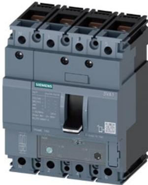
interruttore automatico 3VA1 IEC frame 160 classe del potere di interruzione H Icu=70kA @ 415V a 4 poli, protezione impianto TM240, ATAM, In=160A protezione da sovraccarico Ir=112A...160A protezione da cortocircuito Ii=5...10 x In conduttore di neutro non protetto attacco piatto a vite
