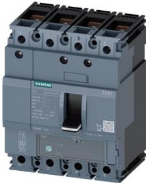
interruttore automatico 3VA1 IEC Frame 160 classe del potere di interruzione M Icu=55kA @ 415V a 4 poli, protezione impianto TM220, ATFM, In=160A protezione da sovraccarico Ir=112A...160A protezione da cortocircuito Ii=10 x In protezione del conduttore di neutro 100% attacco piatto a vite
