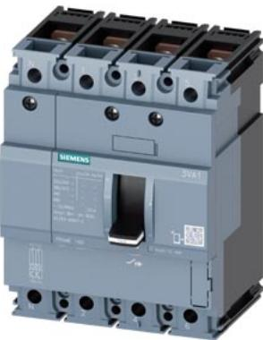
interruttore automatico 3VA1 IEC frame 160 classe del potere di interruzione S Icu=36kA @ 415V a 4 poli, protezione impianto TM210, FTFM, In=160A protezione da sovraccarico Ir=160 A con regolazione fissa protezione da cortocircuito li=10 x In protezione del conduttore di neutro 50% attacco piatto a vite
