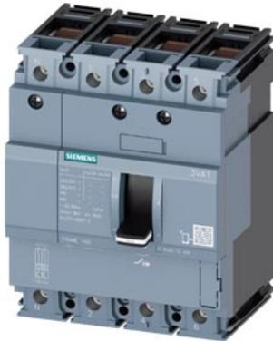
interruttore automatico 3VA1 IEC frame 160 classe del potere di interruzione N Icu=25kA @ 415V a 4 poli, protezione impianto TM210, FTFM, In=160A protezione da sovraccarico Ir=160 A con regolazione fissa protezione da cortocircuito Ii=10 x In protezione del conduttore di neutro 100% connessione a morsetto
