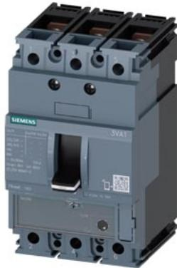
interruttore automatico 3VA1 IEC frame 160 classe del potere di interruzione H Icu=70kA @ 415V a 3 poli, protezione avviatore TM120M, AM, In=125A senza protezione da sovraccarico protezione da cortocircuito Ii=7...16 x In attacco piatto a vite
