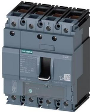
interruttore automatico 3VA1 IEC frame 160 classe del potere di interruzione N Icu=25kA @ 415V a 4 poli, protezione impianto TM220, ATFM, In=125A protezione da sovraccarico Ir=88 A ... 125 A protezione da cortocircuito li=10 x In protezione del conduttore di neutro 100% connessione a morsetto
