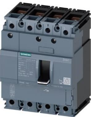
interruttore automatico 3VA1 IEC frame 160 classe del potere di interruzione N Icu=25kA @ 415V a 4 poli, protezione impianto TM210, FTFM, In=125A protezione da sovraccarico Ir=125 A con regolazione fissa protezione da cortocircuito li=10 x In conduttore di neutro non protetto attacco piatto a vite
