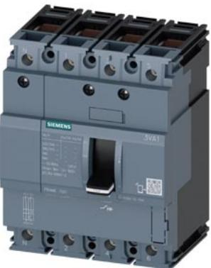
interruttore automatico 3VA1 IEC Frame 100 Classe del potere di interruzione B Icu=16kA @ 415V a 4 poli, protezione impianto TM210, FTFM, In=16A protezione da sovraccarico Ir=16 A con regolazione fissa protezione da cortocircuito Ii=20 x In conduttore di neutro non protetto connessione a morsetto
