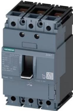
Interruttore automatico 3VA1 IEC Frame 100 Classe del potere di interruzione N Icu=25kA @ 415V a 3 poli, protezione impianto TM210, FTFM, In=32A protezione da sovraccarico Ir=32A impostazione fissa protezione da cortocircuito li=10 x In attacco piatto a vite
