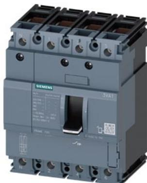
Interruttore automatico 3VA1 IEC Frame 100 Classe del potere di interruzione B Icu=16kA @ 415V a 4 poli, protezione impianto TM210, FTFM, In=32A protezione da sovraccarico Ir=32A impostazione fissa protezione da cortocircuito li=10 x In conduttore di neutro non protetto connessione a morsetto
