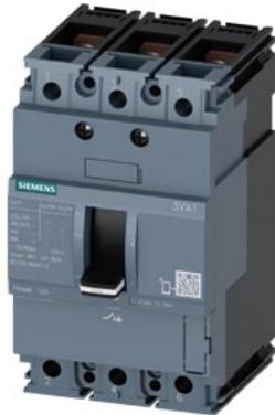
Interruttore automatico 3VA1 IEC Frame 100 Classe del potere di interruzione N Icu=25kA @ 415V a 3 poli, protezione impianto TM210, FTFM, In=20A protezione da sovraccarico Ir=20A impostazione fissa protezione da cortocircuito li=16 x In attacco piatto a vite
