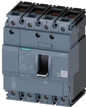
Interruttore automatico 3VA1 IEC Frame 100 Classe del potere di interruzione B Icu=16kA @ 415V a 4 poli, protezione impianto TM210, FTFM, In=20A protezione da sovraccarico Ir=20A impostazione fissa protezione da cortocircuito li=16 x In conduttore di neutro non protetto connessione a morsetto
