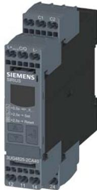
Relè di controllo digitale per il controllo della corrente di guasto con trasformatore differenziale 3UL23 per IO-Link Campo di regolazione 0,03 A ... a 40 A con separazione per soglia di avviso e valore di disinserzione avviamento e ritardo di intervento 0 ... 999,9 s isteresi di disinserzione fino a 50% isteresi di avviso 5% fisso Larghezza 22,5mm, 2 contatti CO con o senza memorizzazione errore tecnica di collegamento a molla
