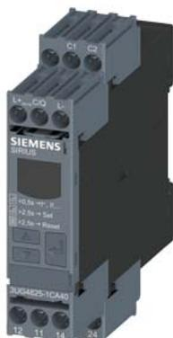
Relè di controllo digitale per il controllo della corrente di guasto con trasformatore differenziale 3UL23 per IO-Link Campo di regolazione 0,03 A ... a 40 A con separazione per soglia di avviso e valore di disinserzione avviamento e ritardo di intervento 0 ... 999,9 s isteresi di disinserzione fino a 50% isteresi di avviso 5% fisso Larghezza 22,5mm, 2 contatti CO con o senza memorizzazione errore morsetto a vite
