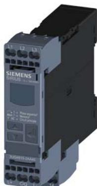
!!! Prodotto di fine serie !!! il successore consigliato è 3UG5816-2AA40 controllo di rete IO-LINK 3X160-690V relè di controllo digitale per tensione di rete trifase per IO-Link AC 50...60 Hz 3 x 160 ... 690 V sequenza delle fasi, mancanza di fase asimmetria delle fasi sottotensione e sovratensione isteresi 1-20 V tempo di stabilizzazione della rete tempo di ritardo di sgancio 1 contatto CO, tecnica di collegamento a molla
