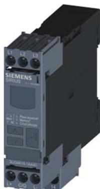
!!! Prodotto di fine serie !!! il successore consigliato è 3UG5816-1AA40 controllo di rete IO-LINK 3X160-690V relè di controllo digitale per tensione di rete trifase per IO-Link AC 50...60 Hz 3 x 160 ... 690 V sequenza delle fasi, mancanza di fase asimmetria delle fasi sottotensione e sovratensione isteresi 1-20 V tempo di stabilizzazione della rete tempo di ritardo di sgancio 1 contatto CO, morsetti a vite
