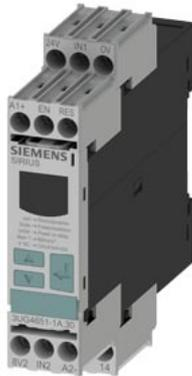
Relè di controllo digitale sorveglianza del numero di giri da 0,1 a 2200 1/min superamento in positivo e in negativo tensione di alimentazione: AC/DC 24 V DC e AC 50...60 Hz senza separazione galvanica dal circuito di misura ritardo all'avviamento 1 fino a 900 s ritardo di sgancio 0.1 ... 99.9 s Isteresi 0.1 ... 99 1/min 1 contatto CO con o senza memorizzazione errore morsetto a vite Prodotto successore per 3UG3051
