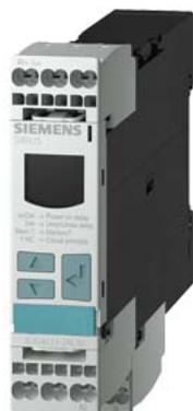
relè di controllo digitale sorveglianza di tensione, 22,5 mm AC/DC 17 ... 275 V superamento in positivo e in negativo autoalimentato ritardo per bypassare i picchi di disturbo 0,1 ... 20 s isteresi 0,1 ... 150 V 1 contatto CO tecnica di collegamento a molla tecnica di collegamento a molla
