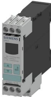
Relè di controllo digitale sorveglianza di tensione, 22.5 mm di 0.1-60 V AC/DC superamento in positivo e in negativo tensione di alimentazione: AC/DC 24 V DC e AC 50...60 Hz senza separazione galvanica al circuito di misura ritardo per bypassare i picchi di disturbo 0,1 ... 20 s Isteresi 0.1 ... 30 V 1 contatto CO con o senza memorizzazione errore morsetto a vite Prodotto successore per 3UG3531-1AC..
