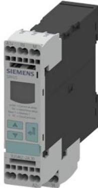
Relè di controllo digitale sorveglianza di corrente, 22.5 mm di 2-500 mA AC/DC superamento in positivo e in negativo AC/DC 24...240V, DC e AC 50 fino a 60 Hz ritardo di avviamento e di picchi di disturbo 0,1 ... 20 s Isteresi 0.1 ... 250 mA 1 contatto CO con o senza memorizzazione errore tecnica di collegamento a molla
