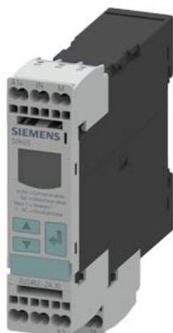
Relè di controllo digitale sorveglianza di corrente, 22.5 mm di 2-500 mA AC/DC superamento in positivo e in negativo tensione di alimentazione: AC/DC 24 V DC e AC 50...60 Hz senza separazione galvanica al circuito di misura ritardo di avviamento e di picchi di disturbo 0,1 ... 20 s Isteresi 0.1 ... 250 mA 1 contatto CO con o senza memorizzazione errore reset automatico tecnica di collegamento a molla
