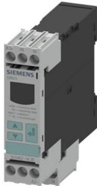
Relè di controllo digitale sorveglianza di corrente, 22.5 mm di 2-500 mA AC/DC superamento in positivo e in negativo tensione di alimentazione: AC/DC 24 V DC e AC 50...60 Hz senza separazione galvanica al circuito di misura ritardo di avviamento e di picchi di disturbo 0,1 ... 20 s Isteresi 0.1 ... 250 mA 1 contatto CO con o senza memorizzazione errore morsetto a vite Prodotto successore per 3UG3521-1AC..
