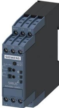
relè di controllo isolamento per reti senza messa a terra (IT-), fino a 250 V AC, 15 ... 400 Hz e fino a DC 300 V campo di misura 1 ... 100 kOhm tensione di alimentazione. AC/DC 24 ... 240V 22,5 mm, 1 contatto CO morsetti a molla (push-in)
