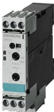
Relè di controllo analogico sorveglianza di livello sorveglianza della resistenza da 2 a 200 kOhm superamento in positivo e in negativo tensione di alimentazione AC/DC 24 V DC e AC 50 fino a 60 Hz senza separazione galvanica al circuito di misura regolazione a 2 punti o a 1 punto ritardo di sgancio 0,5 ... 10 s 1 contatto CO morsetto a vite Prodotto successore per 3UG3501-1AC20
