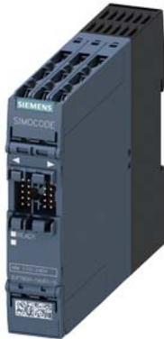
modulo multifunzione, 4 Ingressi e 2 uscite a relè, Tensione di ingresso AC/DC 110-240V Uscite a relè monostabili, rilevamento della corrente di guasto analogica, con trasformatore differenziale 3UL23 Collegamento sensore di temperatura PT100/PT1000/KTY/NTC, max. 1 modulo multifunzione per ogni apparecchiatura base SIMOCODE pro S
