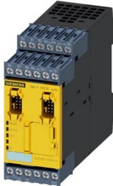
modulo digitale fail-safe DM-F PROFISAFE, al disinserzione fail-safe tramite bus/PROFIsafe, US: 110...240 V AC/DC, 2 circuiti di abilitazione a relè, 2 uscite a relè, 3 ingressi, SIL max. raggiungibile IEC 61508: 3, PL max. raggiungibile ISO 13849-1: E
