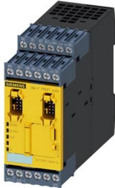
modulo digitale fail-safe DM-F PROFISAFE, al disinserzione fail-safe tramite bus/PROFIsafe, US: DC 24 V, 2 circuiti di abilitazione a relè, 2 uscite a relè, 3 ingressi, SIL max. raggiungibile IEC 61508: 3, PL max. raggiungibile ISO 13849-1: E
