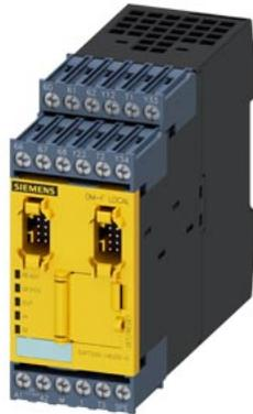
modulo digitale fail-safe DM-F locale, per la disinserzione fail-safe tramite segnale hardware US: 110...240 V AC/DC 2 circuiti di abilitazione a relè, 2 uscite a relè, funzione di sicurezza tramite interruttore DIL impostabile SIL max. raggiungibile IEC 61508: 3, PL max. raggiungibile ISO 13849-1: E
