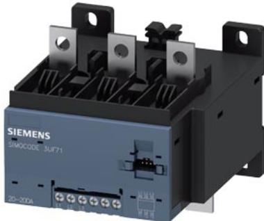
modulo di misura della corrente/tensione V2; corrente di regolazione 20 ... 200 A, misura della tensione fino a 690 V, larghezza costruttiva 120 mm, attacchi a sbarra, richiede apparecchio di base pro V PB, pro V MR, pro V PN oppure pro V EIP
