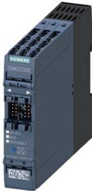
Apparecchiatura base SIMOCODE pro S, Interfaccia PROFIBUS DP 1,5 Mbit/s, 4E/2A liberamente parametrizzabile, US: 110...240 V AC/DC, Ingresso per connessione di termistore uscite relè monostabili, ampliabilità tramite un modulo multifunzione
