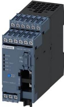
apparecchiatura base SIMOCODE pro V PN, Ethernet/PROFINET IO, ridondanza di sistema PN, OPC UA Server, Web Server, velocità di trasmissione 100 Mbit/s, 2 x connettori di bus tramite RJ45, 4I/3O liberamente parametrizzabili, US: AC/DC 110...240 V, ingresso per connessione di termistore uscite a relè monostabili, ampliabili tramite moduli di ampliamento
