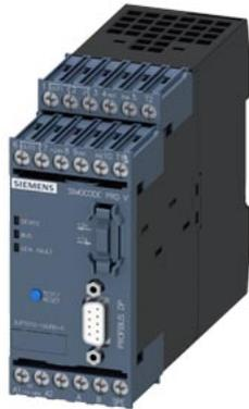
apparecchiatura base SIMOCODE pro V PB, interfaccia PROFIBUS DP 12 MBit/s, RS-485, 4I/3O liberamente parametrizzabili, US: AC/DC 110 ... 240 V, ingresso per connessione di termistore uscite a relè monostabili, con schede di circuito stampato verniciate, ampliabile con moduli di ampliamento
