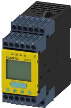
dispositivo di sicurezza SIRIUS di sicurezza sorveglianza del numero di giri AC/DC 110-240 V, 45 mm morsetto a vite circuito di abilitazione istantaneo: 2 NO circuito di abilitazione ritardato: 0 circuito di segnalazione: 2 elettrico versione NAMUR avvio automatico/avvio manuale apparecchio di base PL max. raggiungibile secondo EN 13849-1: e SIL max. raggiungibile secondo IEC 61508: 3
