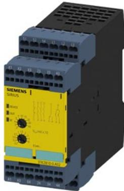
dispositivo di sicurezza SIRIUS di sicurezza sorveglianza di fermo AC 230 V, 45 mm morsetto a molla circuito di abilitazione istantaneo: 3 NO + 1 NC circuito di abilitazione ritardato: 0 circuito di segnalazione: 3 avvio automatico apparecchio di base cat. max. di errore EN 954-1: 4 PL max. raggiungibile secondo EN 13849-1: e SIL max. raggiungibile secondo IEC 61508: 3
